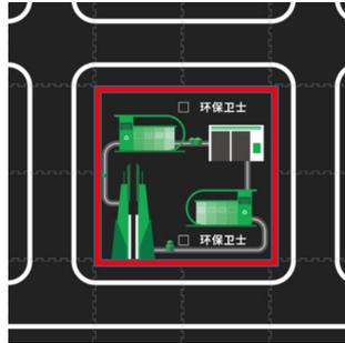
智能车将垃圾桶成功投放入垃圾回收站范围中且投放后垃圾桶垂直投影不超过垃圾回收站范围，垃圾回收站范围如下图红色标记框范围所示，视为完成垃圾桶投放。垃圾回收站范围尺寸为20cm\*44cm。垃圾回收站分为“有害垃圾”和“可回收垃圾”两个区域，每个区域占总区域的一半，尺寸为20cm\*22cm。将蓝色“可回收垃圾桶”投放入“可回收物”区域以及将红色“有害垃圾桶”投放入“有害垃圾”区域，则视为正确投放入垃圾回收站中。如果因后续投放的垃圾桶导致先前投放的垃圾桶脱离垃圾回收站，则先前投放的垃圾桶不得分。
