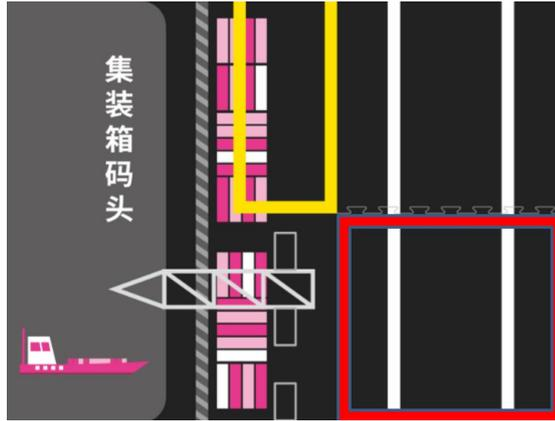
智能车将集装箱成功投入集装箱放置区范围中且投放后集装箱垂直投影不超过集装箱放置区范围，集装箱放置区范围如下图红色标记框范围所示，视为完成集装箱投放。集装箱放置区范围尺寸为 20cm\*44cm。如果因后续放置的集装箱导致先前放置的集装箱脱离放置区，则先前放置的集装箱不得分。
